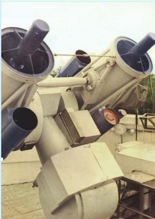
Телескоп траекторных измерений
