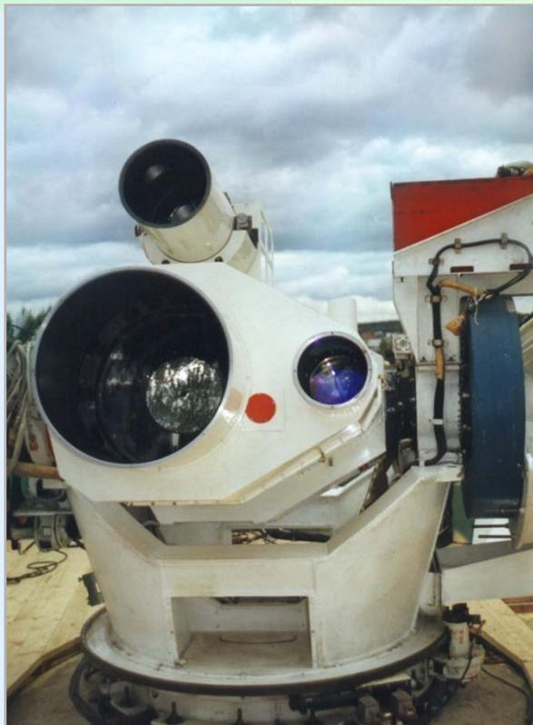
Телескоп траекторных измерений
