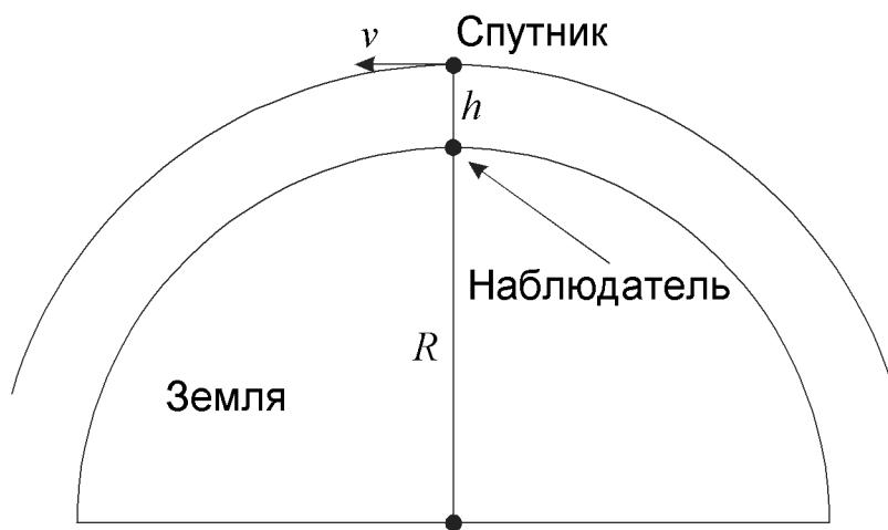
Обозначим радиус Земли через  $R$ , расстояние между наблюдателем и спутником – через  $h$ , период обращения спутника – через  $T$ . Орбита спутника круговая, и по III закону Кеплера
