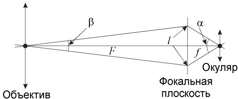
Изображение объектов строится в фокальной плоскости и рассматривается через окуляр. Обозначим фокусное расстояние окуляра через  $f$ , а его собственное поле зрения через  $\alpha$ . Тогда линейный размер изображения поля зрения в фокальной плоскости равен
