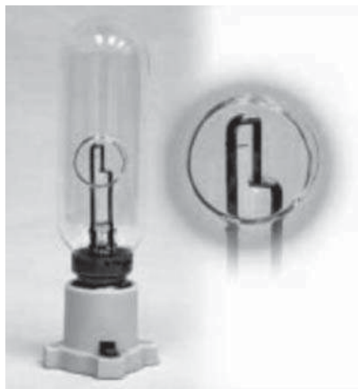
Рис. 7.2. Ленточная спектрофотометрическая лампа
