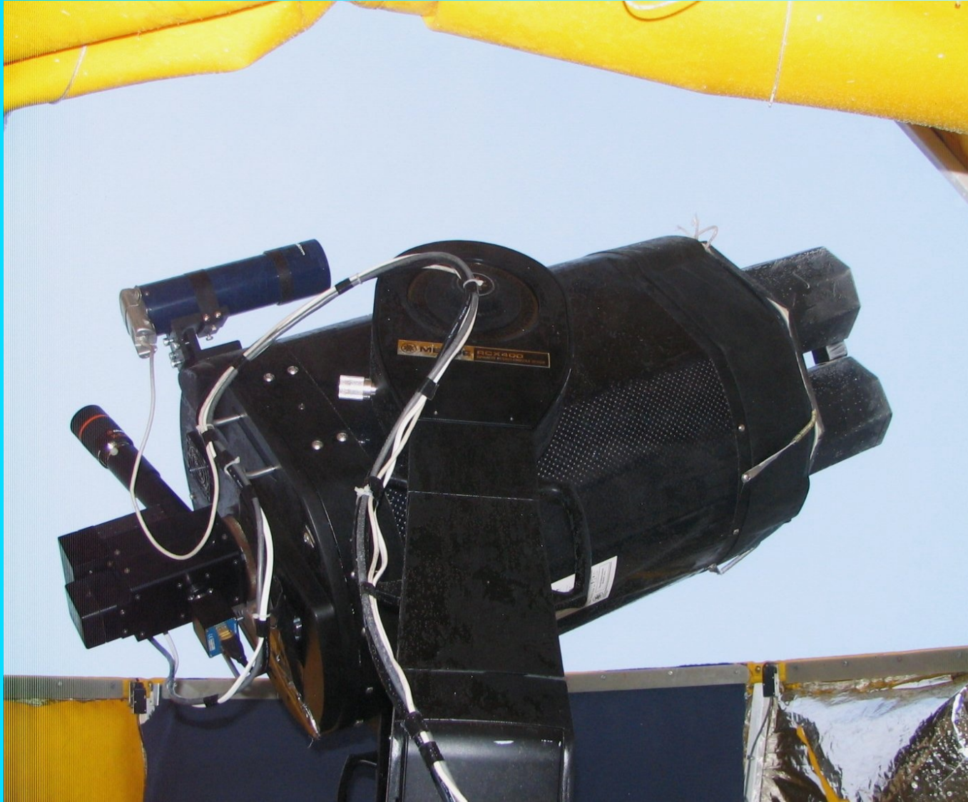
Телескоп RCX400 с прибором MASS/DIMM и специальным противоросником. Март 2008
