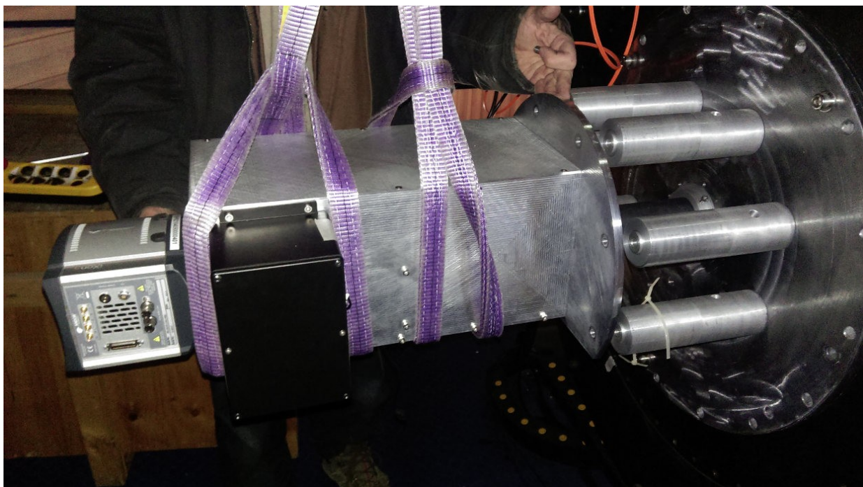
Рис. 3: Стрповка оптикомеханического модуля и подведение его к интерфейсу в фокусе Нэсмит-2
