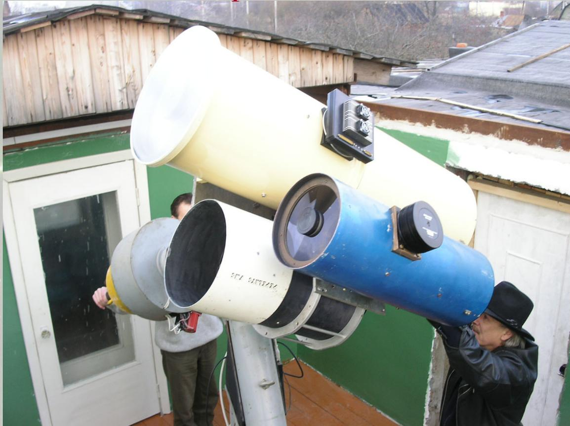
Прибор MASS для изучения вертикального профиля оптической атмосферной турбулентности, созданный в сотрудничестве с обсерваторией Cerro Tololo (Чили) и предназначенный для мониторинга (в т.ч. дистанционного) в местах возможной установки крупных телескопов и адаптивных систем (доц. В.Г.Корнилов, доц. Н.И.Шатский). Используется для поиска мест установки 30-м и 100-м оптических телескопов, а также в Антарктиде.
