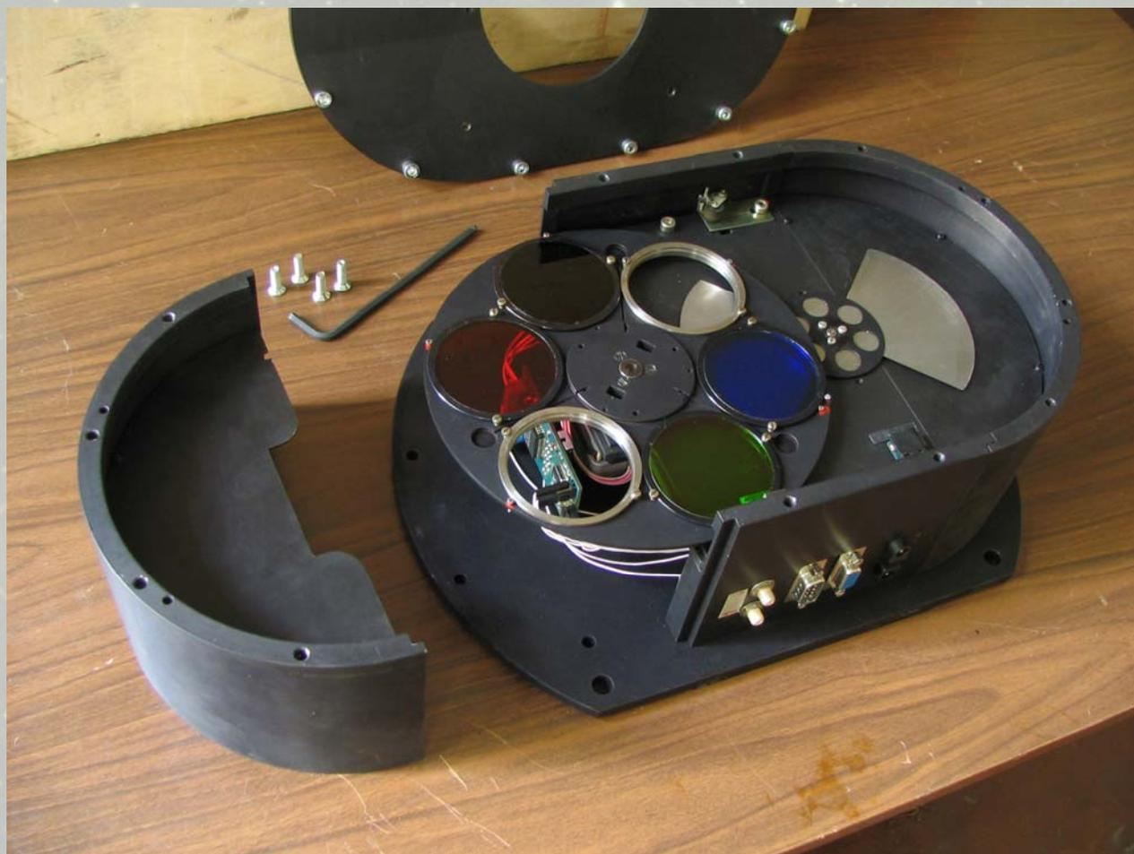
WBVRI фотометр: камера, контроллер и блок фильтров.
