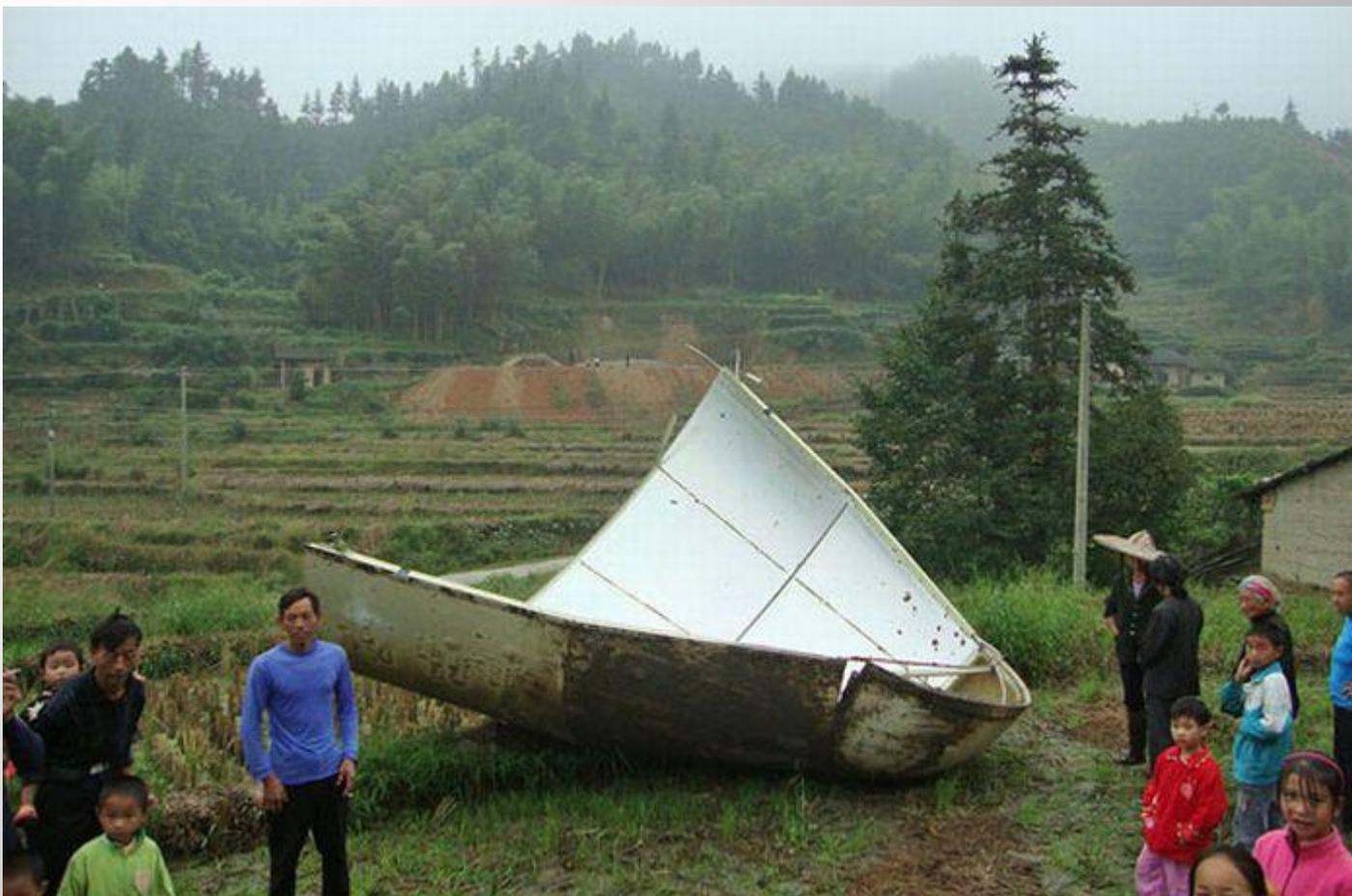
**Рис.15. Фрагмент головного обтекателя РН после падения в населенном пункте. [http://cdn.trinixy.ru/pics4/20101005/surprise\\_from\\_the\\_sky\\_01.jpg](http://cdn.trinixy.ru/pics4/20101005/surprise_from_the_sky_01.jpg)**
